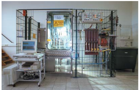
Cabine for 5000h accelerated weather ageing test / Kabine für den 5000h beschleunigten Alterungstest
