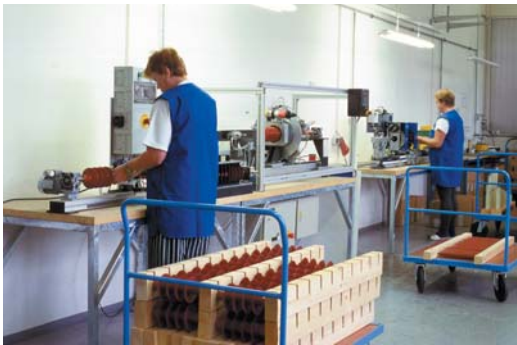
Semi-automatic special machineries for assembly of polymer arresters of modular construction. / Halbautomatische Spezialmaschinen zur Montage von Kunststoffableitern in modularer Ausführung.
